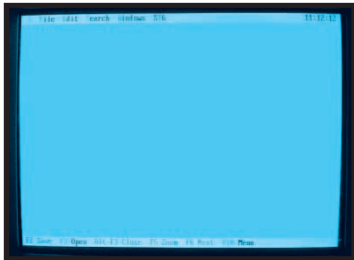
Fig.1 Per duplicare il programma STANDARD.ASM dovreste prima richiamare l'Editor, scrivendo C:\>ST6 poi Enter. Dopodichè scriverete C:\ST6>ST6 e a questo punto potrete premere il tasto Enter.
