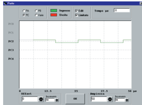
Fig.20 Dopo le operazioni visualizzate nelle due figure precedenti, sul piedino PC2 è ora presente una forma d'onda quadra con un periodo di 10 cicli.
