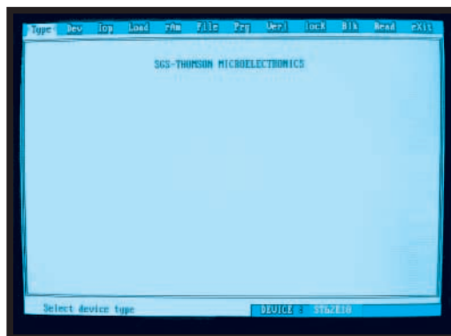
Fig.18 Prima di programmare l'ST62E25 controllate attentamente che nel riquadro in basso appaia ST62E25. Se appare un'altra sigla dovrete ritornare alla fig.17.
