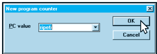
Fig.112 Grazie a questa finestra di dialogo potete far partire l'esecuzione del programma dall'etichetta ripeti .
