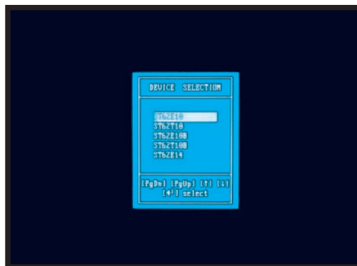
Fig.17 Come vedrete, sullo schermo apparirà una finestra con tutti i tipi di ST62. Con i tasti freccia ricercate la sigla ST62E25 poi pigiate il tasto Enter.
