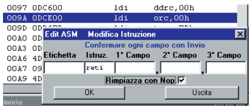
Fig.9 Se l'istruzione modificata è più lunga o più corta di quella originale, potete rimpiazzare i bytes mancanti con dei NOP.
