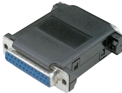
Fig.3 Foto dell'interfaccia già montata e, in basso, già racchiusa all'interno del suo piccolo contenitore plastico.
